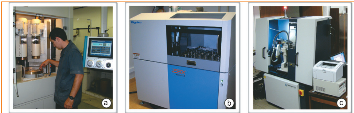
Figura 25 - a) Laminadora automática Astera; b) Espectrômetro de fluorescência de raios X (Rigaku) e c) Difrátômetro de raios X (Rigaku) nos laboratórios do Instituto de Geociências da UnB.
