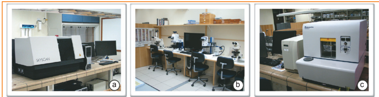
Figura 23 - a) Microtomógrafo Sky Scan 1173; b) microscópios do Laboratório de Petrologia Sedimentar e c) analisador de partículas por RX – Sedigraf do Laboratório de Geologia Sedimentar da UFRJ - Lagesed.
