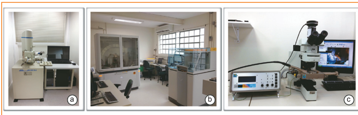
Figura 29 - a) Microscópio eletrônico de varredura (MEV) JEOL 6010 LA; b) visão interna do prédio do Labocal na UFPR e c) sistema de catodoluminescência.
