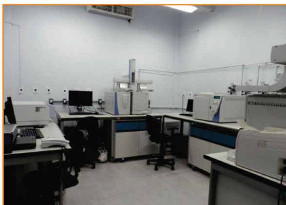
Figura 75 - Laboratório de Geoquímica Orgânica da UFF, equipado com GC, GC/MS e espectrofotômetro de fluorescência.
