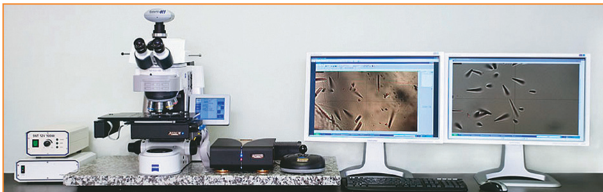
Figura 99 - Sistema automatizado para aquisição de dados de traços de fissão - Autoscan Deluxe , composto de um microscópio Zeiss Axio-Imager Z2m motorizado, dois softwares ( Trackworks e FastTracks ), 2 monitores de alta resolução LCD 24" e câmera digital a cores.
