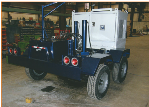
Figura 50 - Fonte sísmica do tipo minivibrador adquirido para o Laboratório de Aquisição, Processamento e Interpretação Sísmica da UFF.
