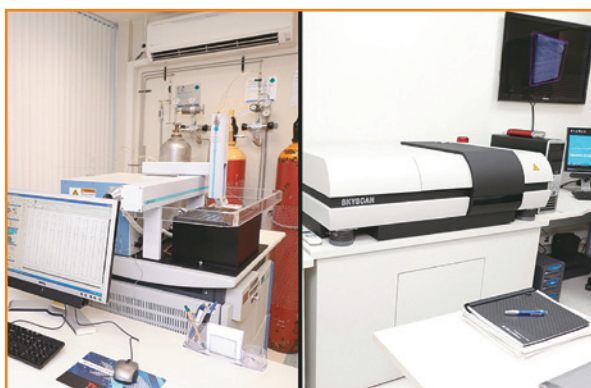
Figura 8 - Espectrômetro de massa para Carbono e Oxigênio (à esquerda) e microtomógrafo (à direita) no Laboratório de Isótopos Estáveis da UFPR.
