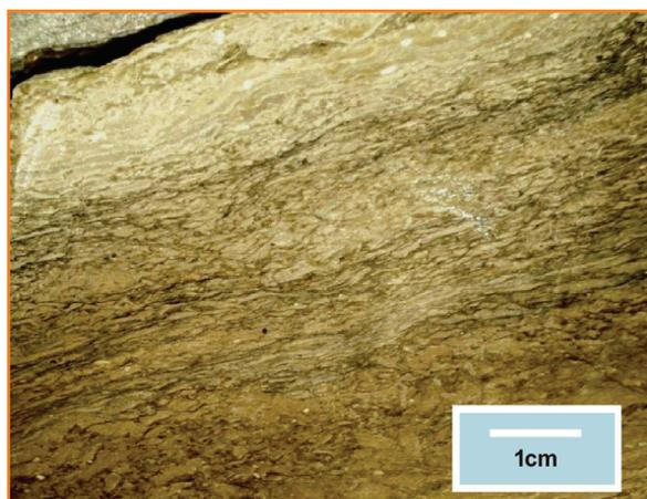
esbranquiçados, que se intercalam com carbonatos finos escuros com laminação plano-paralela ou truncada ondulante. Esta laminação é observada devido à variação no teor de material orgânico. Fraturas, falhas e dobras convolutas podem ser notadas em alguns intervalos. Localmente, ocorrem concentrações de cocóides.
