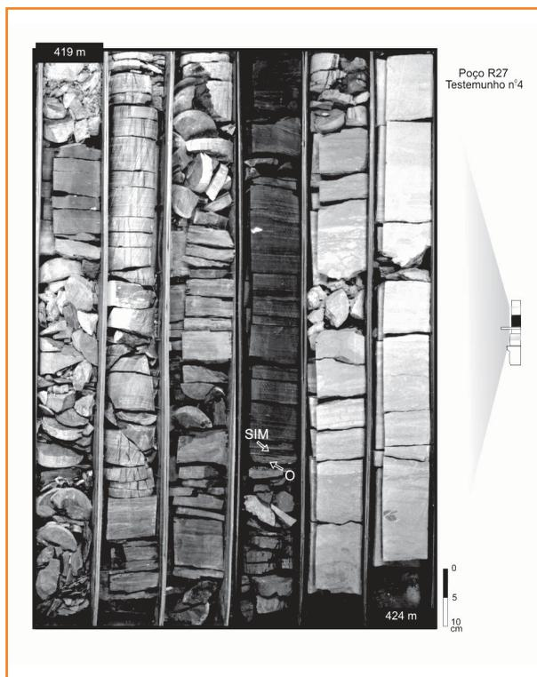
Figura 18 – Superfície de inundação máxima (SIM) da seqüência le (poço R27, veja fig. 11), posicionada na base de um corpo de folhelho preto, logo acima de uma delgada camada de ostracodito (O).
