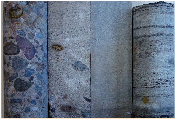
Figura 25 - Fácies trativas comuns nos depósitos hiperpicnais de alta energia do Canyon de Almada.
