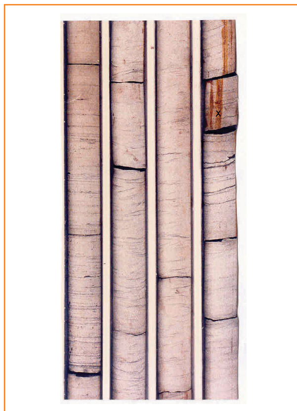
Figura 9 – Seqüência S_3 , trato inferior. Arenitos com laminação horizontal (raia esquerda), laminação cruzada clino-ascendente, e estratificação cruzada com drapes argilosos (X, raia direita). Poço PP-10, caixa 42.
