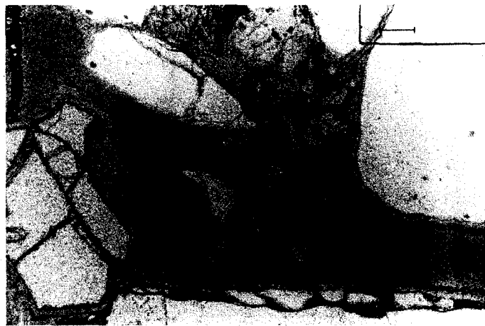
Foto 2 - Franjas de esmectita recobrimdo os grãos do arcabouço e em agregados preenchendo o poro. Poço 3, prof. 1 347,85 m; //N; campo 0,8 X 1,2 mm; aumento 70 X.
