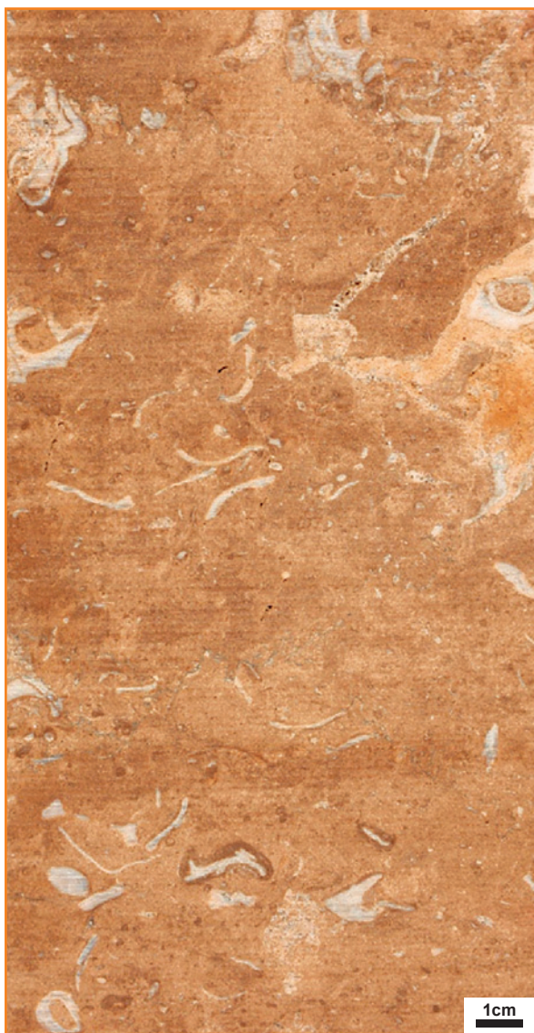
Figura 3 - Rudstone bioclástico/oncolítico/peloidal, com matriz. Formação Quissamã, Bacia de Campos. Fatia de testemunho.
