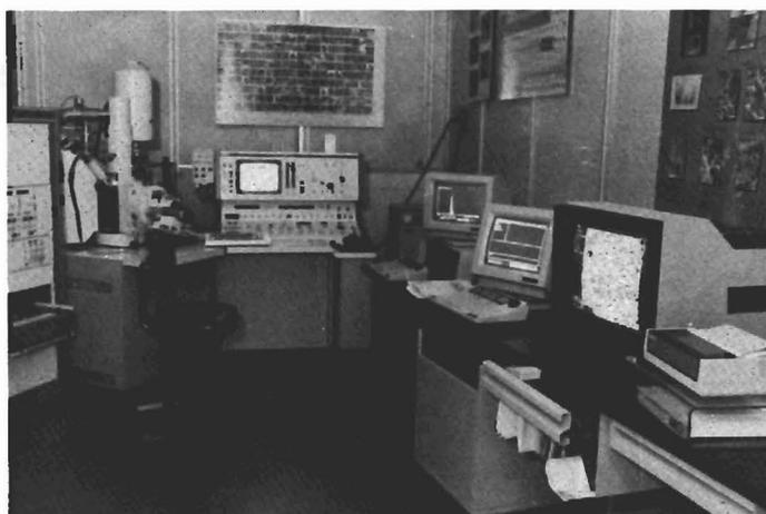
Foto 1 - Laboratório de microscopia eletrônica de varredura (MEV) do CENPES/DIGER/SEGRES mostrando o microscópio eletrônico Jeol 840, o sistema de energia dispersiva (EDS) e o analisador de imagens (AI), ambos da Tracor/Northern.
