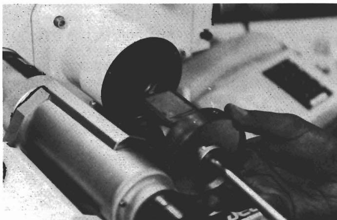
Foto 2 - Porta-amostra com uma lâmina delgada metalizada com fina película de carbono para ser analisada pelo MEV.
