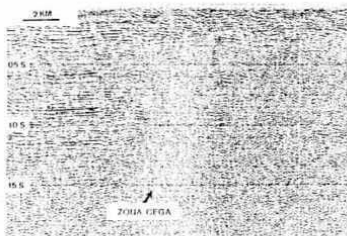
Fig. 4 - Linha sísmica 225-RL-01, ilustrando um dique intrudido em sedimentos paleozóicos da Bacia do Paraná (Zalán et al. 1991).
