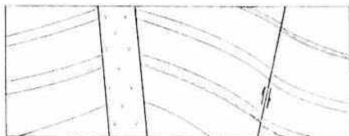
Fig. 29 - Dique com dobras e falhas reversas
