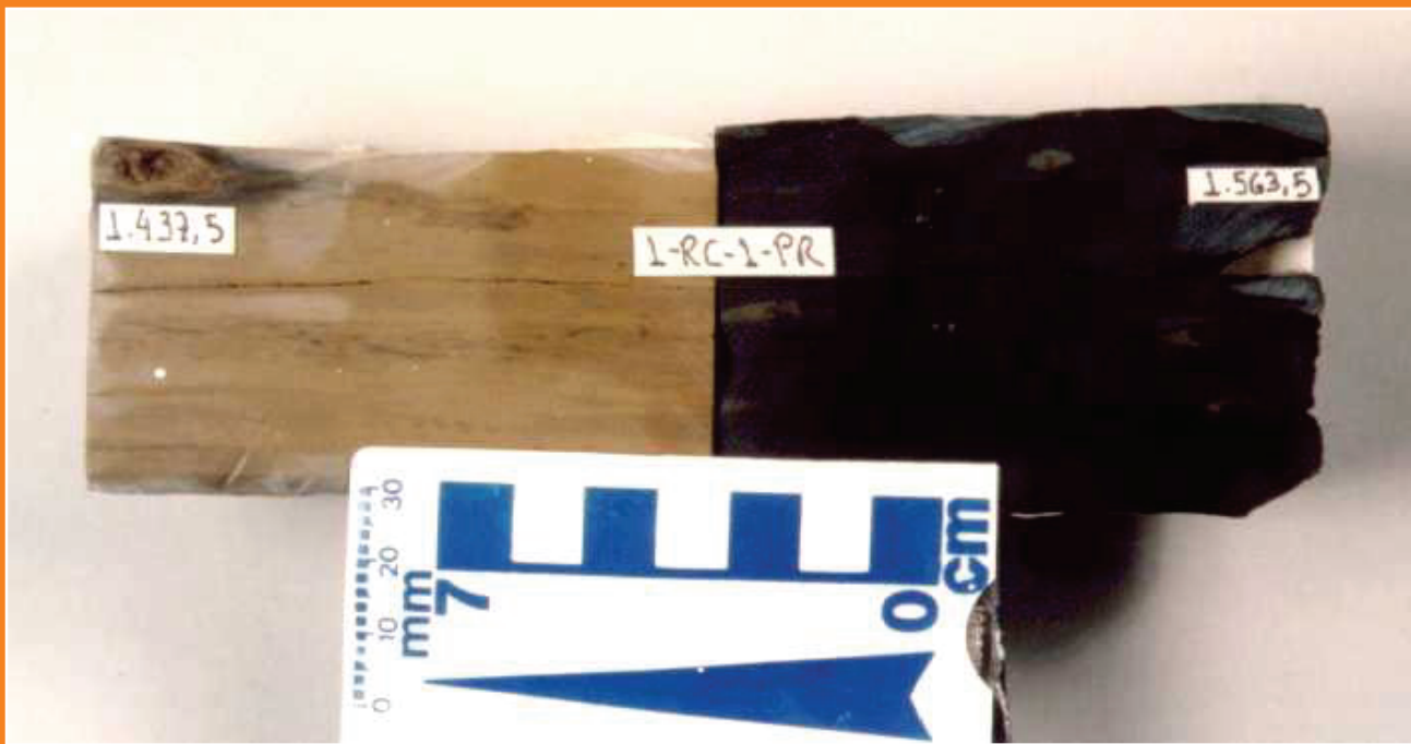
Figura 32 – A seção inferior da Formação Ponta Grossa inclui um intervalo de folhelhos pretos laminados, mostrado aqui em pedaço de testemunho. Observar que, quando intrudido nas proximidades por diabásios, estes folhelhos (pedaço da esquerda) perdem completamente seu conteúdo orgânico.
