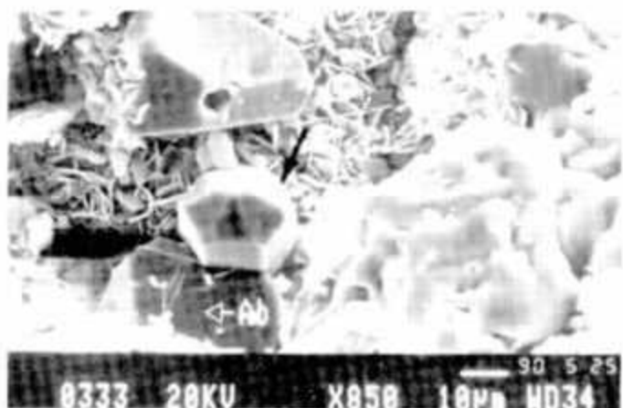
Foto 14 - Imagem ao MEV mostrando cristais tardios de quartzo (Q) e albita (Ab) precipitados sobre franjas de clorita precoce.
