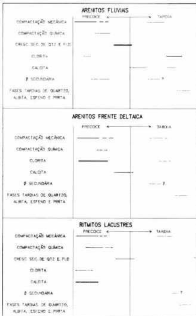
Fig. 10 - Diagrama mostrando as sequências diagenéticas dos arenitos das três principais fácies sedimentares da Formação Pendência no Campo de Pescada.
