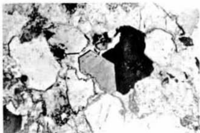
Foto 18 - Anquerita preenchendo a porosidade secundária ressaltada pelas formas euédricas do quartzo. No centro da foto, um cristal de esfalerita subédrica e zonada substitui o carbonato. LP, 1/4, 248x.
