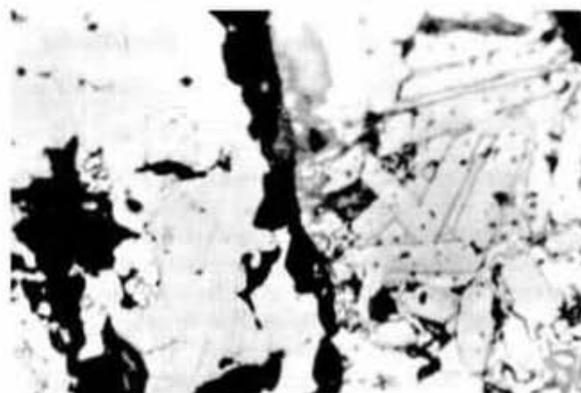
Foto 4 - Agregados de cristais prismáticos de rutilo (Ru) com disposição em treliça, que evidencia o seu desenvolvimento sobre lamelas de exsolução de antigas titanomagnetitas detriticas. A hematita II (He) e os sulfetos (bornita II, Bo) são posteriores. Oleo, LN, 496x.
