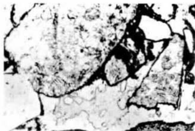
Foto 16 - Poro secundário amplo e alongado, delineado por cristais de quartzo que cresceram centripetamente como projeções alongadas segundo o eixo c, com terminações euédricas nos espaços vazios. A porosidade remanescente está preenchida por barita telodiagenética. Observe a heterogeneidade de empacotamento e os contatos interpenetrados. LN, 39x
