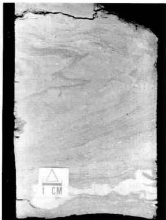
Foto 3 - Fácies caótica com intensa laminação formada pela deformação de outras estruturas (traços fósseis e acamamento original). Eoceno, poço 1-RJS-90, intervalo 2.883,7 a 2.883,8 m.
