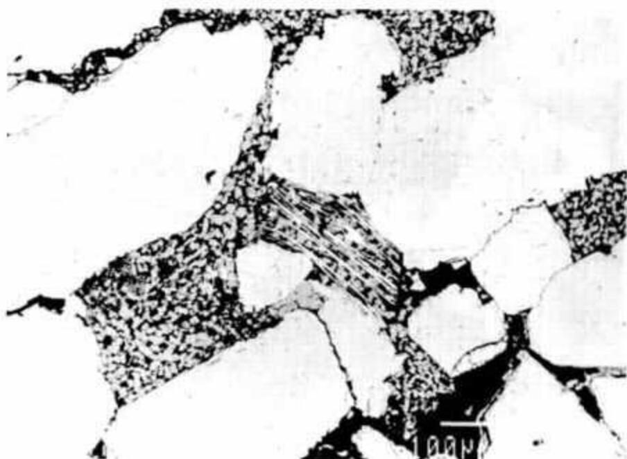
Foto 4 - Agregados de caulinita ocupando a porosidade intergranular em arenito com compactação química e crescimentos secundários. Mica caulinizada. 7 CB 6D SES, 1 995,5 m. Imagem BSE.
