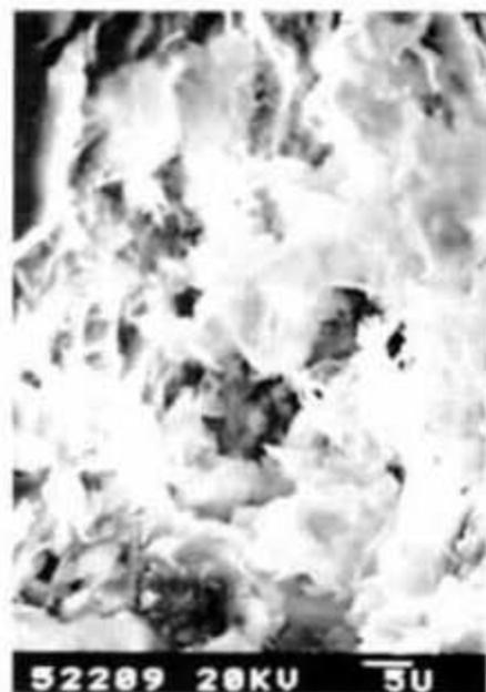
Foto 6 - Fotomicrografia de microscopia eletrônica de varredura (MEV), mostrando interestratificado de illita-esmectita. Poço 7-FBE-23-BA, 2 520,7 m.
