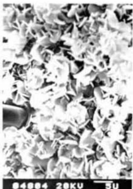
Foto 8 - Fotomicrografia de MEV, mostrando cutículas de clorita autigênica sobre grãos detritais. Poço 7-FBE-31-BA, 2 438,4 m.
