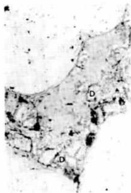
Foto 2 - (Poço 1-RUC-1-AM; 2 437,5m; 400X; nicóis paralelos) - Lâmina delgada mostrando detalhe de um poro parcialmente preenchido por romboedros de dolomita ("D").
