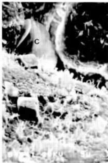
Foto 3 - (Poço 1 RUC-1 AM; 2 437,5m; 1400X); - Fotomicrografia ao microscópio eletrônico de varredura (MEV) de grãos do arcabouço revestidos por material illítico, onde as illitas filamentosas orientam-se perpendicularmente ao grão. Notar em "C", cloritas preenchendo o espaço intergranular. Photo 3 SEM photomicrograph of framework grains covered with illite material, with filamentous illites running perpendicular to the grain (Well 1 RUC-1 AM; 2 437.5m; 1400X). Observe chlorites filling intergranular space (C).
