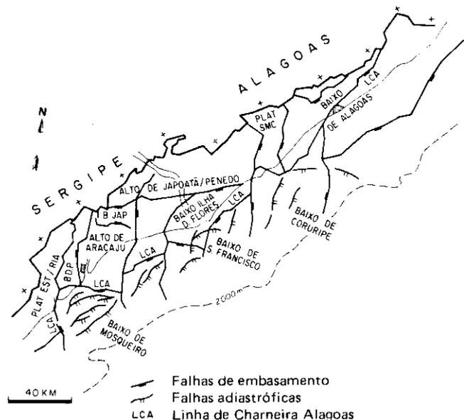
Fig. 3 - Principais feições tectônicas da Bacia de Sergipe-Alagoas (adaptado de Falkenhein *et al.*, em edição).
