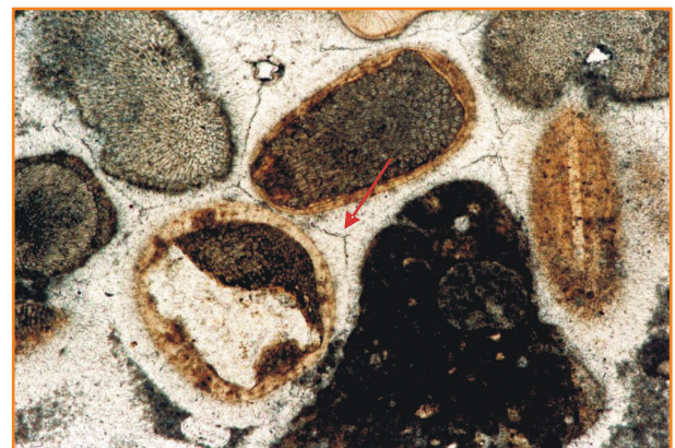
Figura 2 – Margem da plataforma, Bacia de Campos (Holoceno): grainstone com espessa franja (seta) marinha fechando totalmente os poros.
