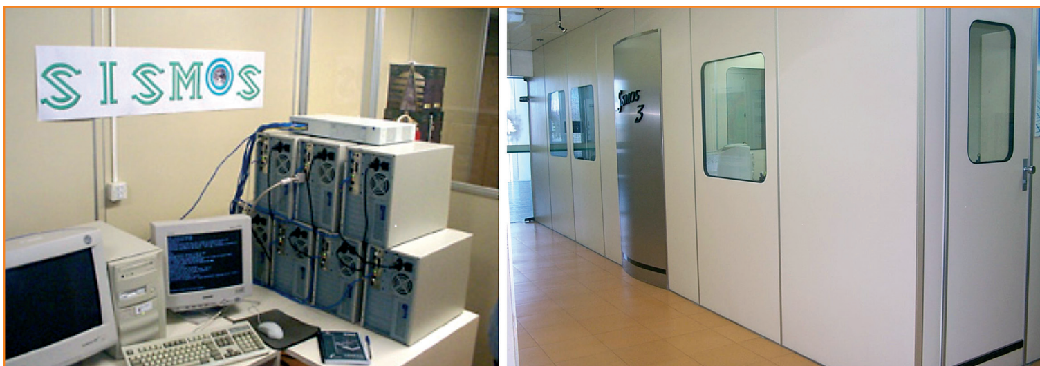
Figura 25 – Diferentes versões do cluster de computadores do Cenpes: (a) o Sismos 2, com oito máquinas em paralelo (em 2000); (b) o Sismos 3, com 72 máquinas em paralelo (final de 2000), então instalado numa sala do Cenpes.
