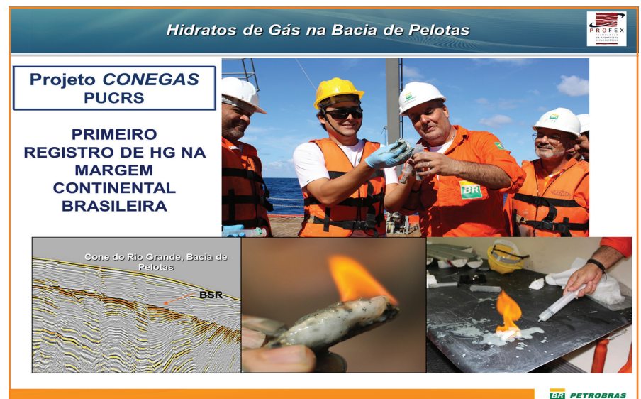
Figura 31 – Recuperação de amostra de gás em testemunho a pistão obtido no Projeto Conegas, em área de ocorrência de Bottom Simulating Reflector (BSR), artefato sísmico que sugere presença de hidrato de gás, evidenciado na linha sísmica, na porção inferior esquerda da imagem. No canto inferior direito, imagem do hidrato queimando em laboratório do navio oceanográfico.
