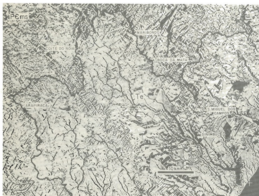
Foto 2 - Observe-se a diferença entre a zona isomórfica relacionada aos metassedimentos (Pems) e a relacionada às rochas terciárias da Formação Barreiras (Te). Aparecem as linhas de foliação dos metassedimentos e os traços formados pelos níveis mais resistentes dos dobramentos holomórficos. Na porção setentrional, à direita, destaca-se o traço da falha Maribondo-Cajueiro, orientada para N40E, em cuja continuação para SW são visíveis alguns alinhamentos. No canto SW, observa-se o aspecto serrilhado da borda sul do anticlinal do Jirau do Ponciano, formado pela intersecção dos alinhamentos N20-30E e N10-25W. No canto SE, observe-se a expressão circular ao sul do Sinimbu.
