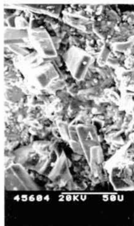
Foto 5 - Crescimento secundário de feldspato (A - albita) formado na segunda fase de cimentação. Poço 7-RBU-6-BA, 899,7 m - MEV.
