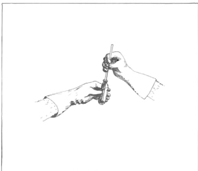
Fig. 26 - Retirar um pouco de resíduo orgânico com canudo de refresco.
