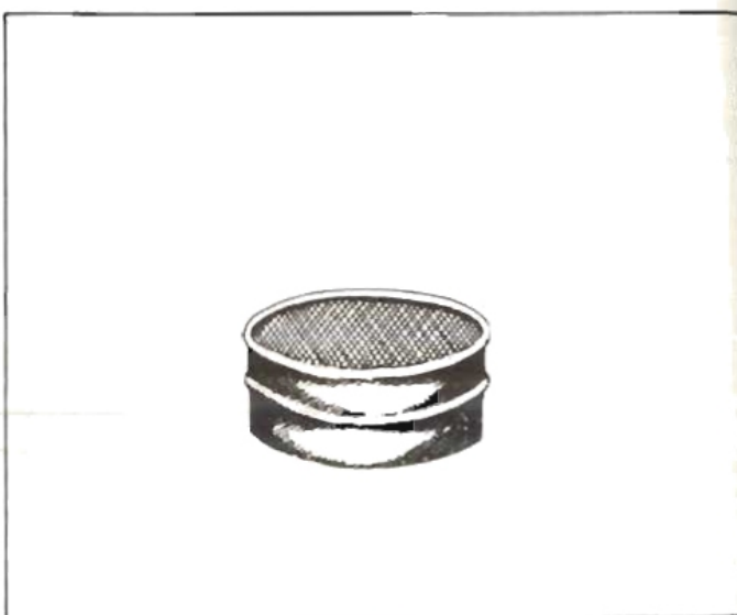
Fig. 4 - Passar o material pela peneira de malha de 2,83 mm, Tyler 7. Caso fiquem retidos fragmentos na malha, retirá-los e triturá-los com martelo sobre uma bigorna, recolocando-os em seguida na peneira. Repetir o processo enquanto necessário.
