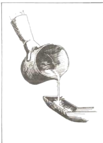
Fig. 7 - Decantar cuidadosamente o HF (se estiver límpido).
