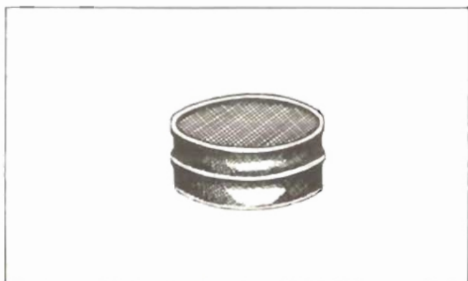
Fig. 33 - Em sedimentos paleozóicos, é importante fracionar o resíduo orgânico total em grosso ( >0,088 mm) e fino ( <0,088 mm). Passar o resíduo em peneira de malha de 0,088 mm, colocando o material fino em vidrinho, para montagem de lâmina, e o material grosso em papel de filtro, para seleção dos microfósseis na lupa.
