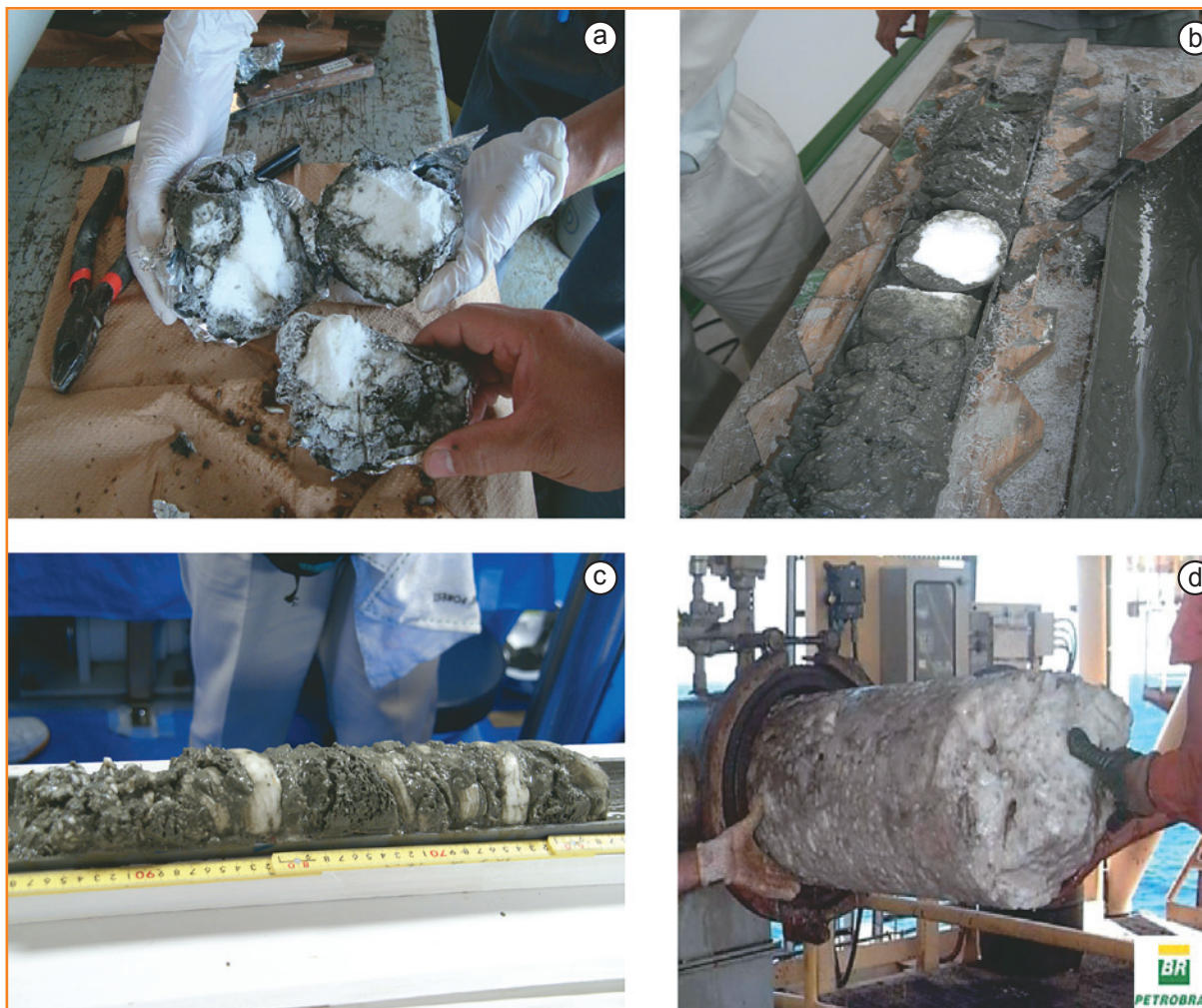
Figura 1 (a) Blocos de hidratos naturais de gás amostrados através de testemunhadores a pistão Calypso em sedimentos quaternários do Mar do Japão, sobre o anticlinal Umitaka, durante a missão de pesquisas MD-179 em 2010; (b) nódulo de hidrato imerso em matriz lamosa, coletado pelo piston-core PC-09 durante o cruzeiro de pesquisas UT-07 no Mar do Japão; (c) lâminas de hidratos preenchendo fraturas em sedimentos lamosos, coletados pelo piston-core PC-915 durante o cruzeiro de pesquisas UT-09 no Mar do Japão; (d) bloco de hidrato de gás formado dentro de tubulação de produção na Bacia de Campos (cortesia da Petrobras; demais fotos feitas pelo autor).
