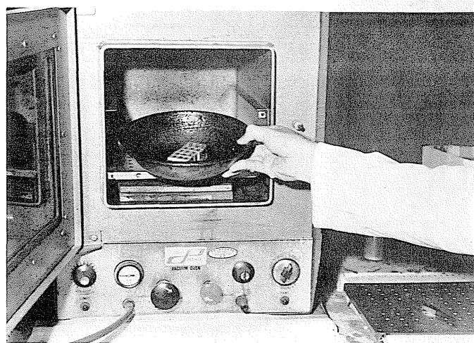
Foto 5 - Colocação das amostras dentro de recipiente metálico para impregnação em estufa à vácuo. Photo 5 - Setting of samples within a metallic container for impregnation in vacuum oven.
