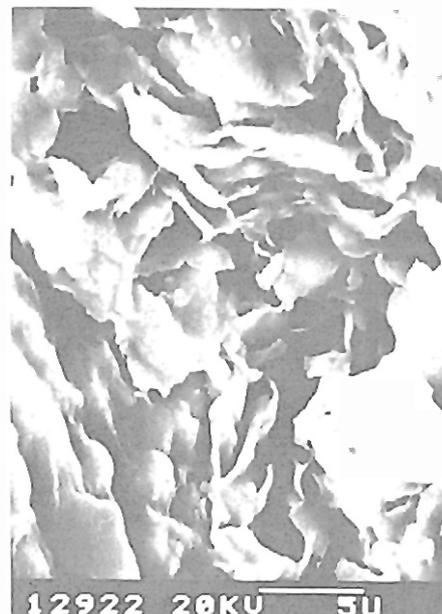
Foto 19 - Hábito detritico em argilas esmectíticas infiltradas. Observar a elevada área superficial dos agregados. Regeneração muito incipiente denunciada por algumas projeções pontiagudas nos cantos das lamelas. Formação Sergi, poço 7-FBM-30-BA, 1 181,75 m. MEV. Escala =  $5 \mu$ .
