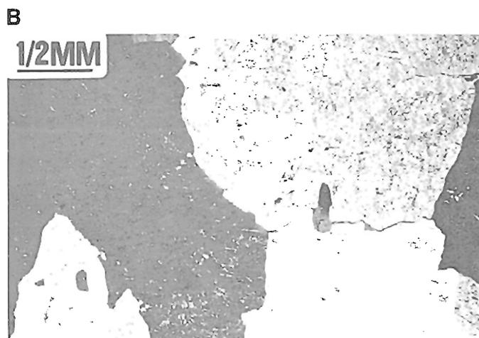
Foto 7 - Amostra de mão indicando as rosetas de gipsita (a) e microfotografia de gipsita porfiroblástica (b) (com abundantes ripas corroídas de anidrita), representando fácies secundária dos evaporitos.
