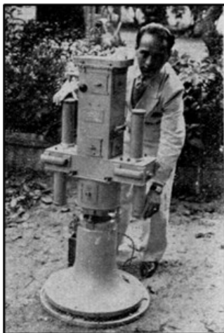
Figura 1. Balança de torção Oertling e, à direita, seus componentes. Na imagem, o engenheiro-geofísico Henrique Capper Alves de Souza, um dos pioneiros da geofísica brasileira, trabalhando pelo SGMB (Amaral e Souza, 1936).
