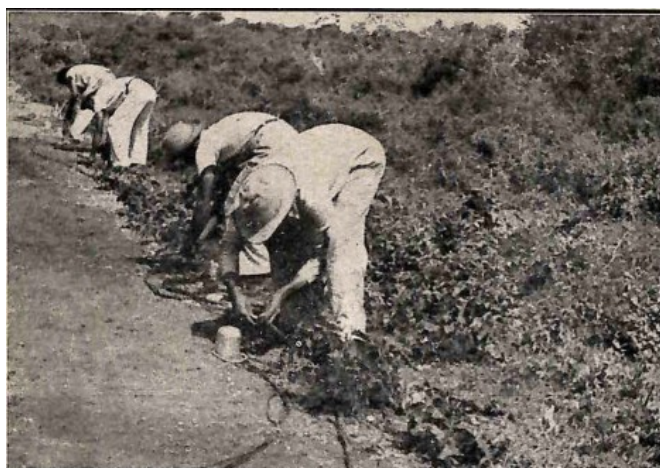
Figura 14. Geofones sendo “plantados” para os registros sísmicos (CNP, 1946).
